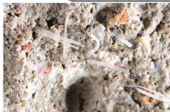
Makroansicht von FASERFIX® Beton. Gut zu erkennen sind die Fasern, die dem Werkstoff seine hohe Festigkeit verleihen.
