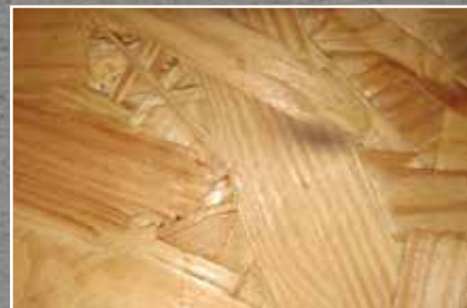
Holzfaserplatten erhalten ihre hohe Stabilität durch ein dicht verwobenes Fasernetz.
